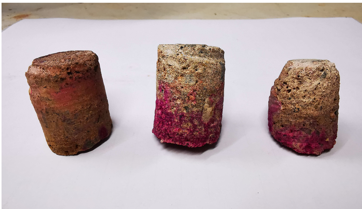
Obr.1: Vrtná jádra po nástřiku fenolftaleinem – opěra Choltice
