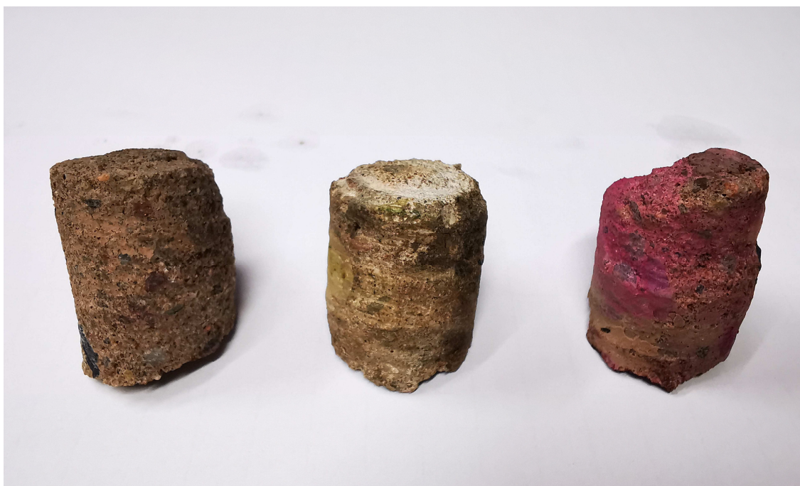
Obr.2: Vrtná jádra po nástřiku fenolftaleinem – opěra Heřmanův Městec
